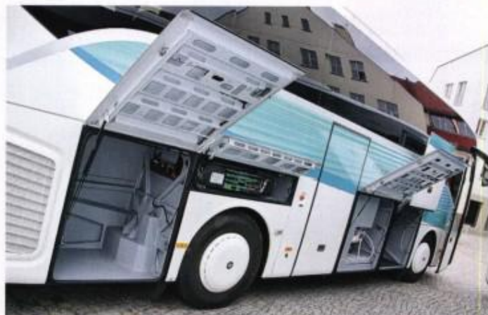
Багажный отсек, в этом же пространстве расположились аккумуляторы, предохранители, реле и другое оборудование
