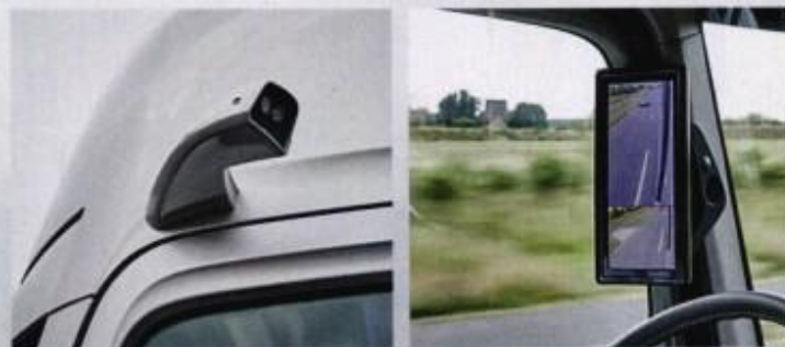
Мониторы на стойках выводят информацию с боковых камер – они заменяют зеркала заднего вида
